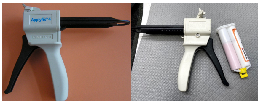
Figura 79. Pistol cu funcție de automalaxare și material sub formă de cartuș.
