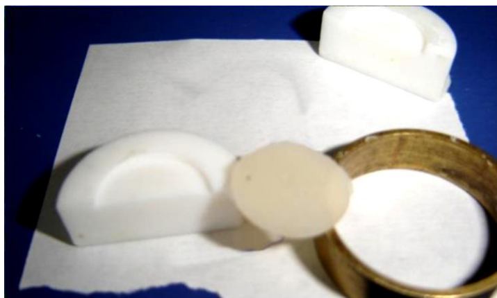
Figura 1.7 Proba de test scoasă din matriță înainte de a fi plasată în baia termostatăă (7)
