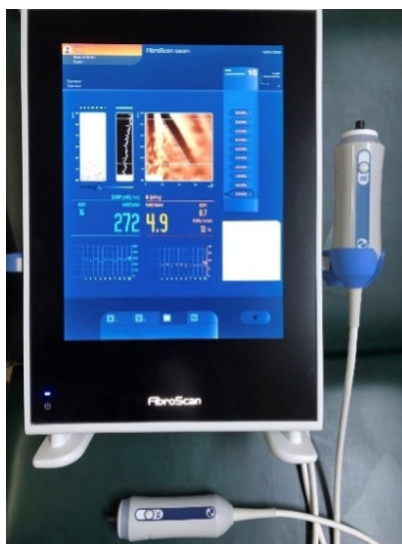
Figura 18.3. Aparatul FibroScan, utilizat pentru elastografia impulsională, o tehnică non-invazivă care măsoară rigiditatea hepatică.
