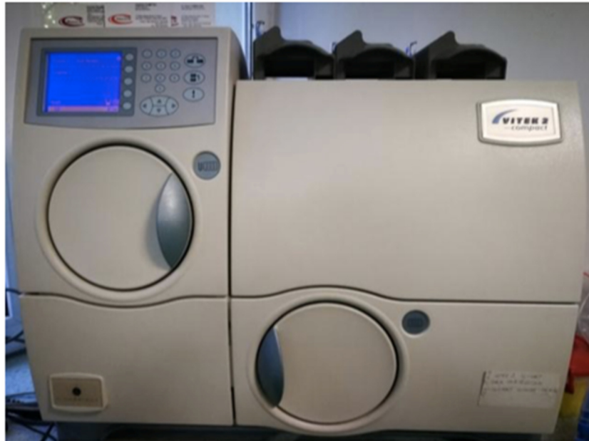
Figure 15 : VITEK 2 COMPACT, système automatisé d'identification et de tests de sensibilité.
