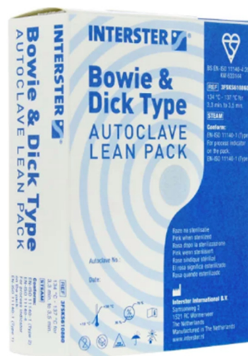
Figure 4 : Test de stérilisation Bowie & Dick.
