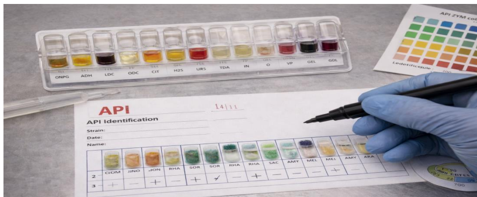
Figura 25. Test API – sistem de identificare bazat pe reacții biochimice, evidențiate prin modificări de culoare și interpretate prin cod numeric.
